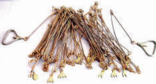
Pour mesurer des terrains on utilisait une chaîne de fer pliable d'un décamètre de long :
